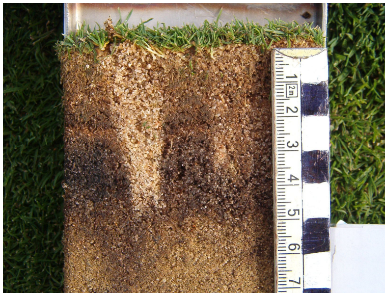
Was die Golfer nicht sehen: Bodenausstich eines Grüns mit sandverfülltem Aerifizierloch
